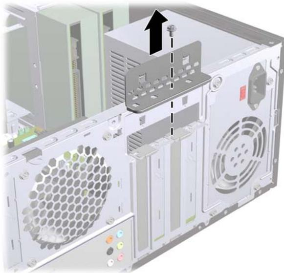
8. Antes de instalar uma placa de expansão, remova a tampa dos slots de expansão ou a placa de expansão existente.
