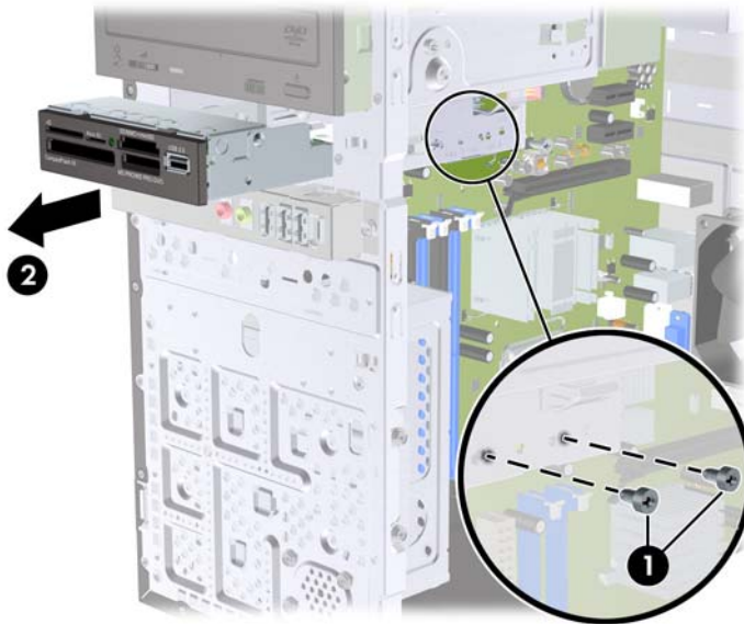
Figure 19 Retrait d'un périphérique 3,5 pouces (lecteur de carte multimédia illustré)
