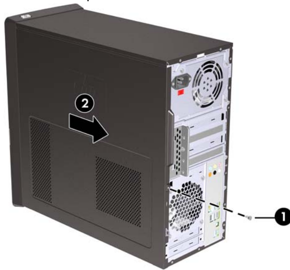
Figure 1 Retrait du panneau d'accès à l'ordinateur
