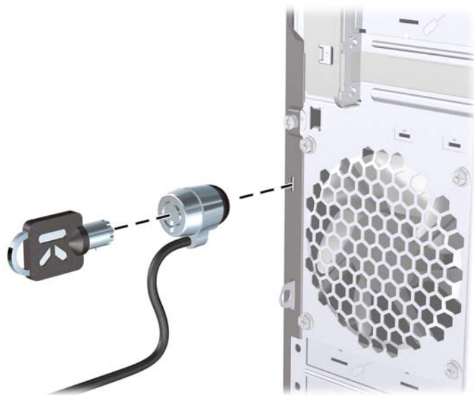
Attēls 33 Kabeļa aizslēga uzstādīšana
