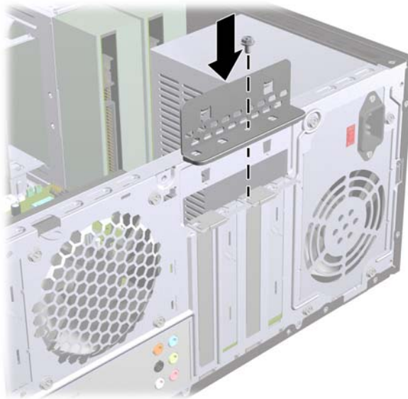
Attēls 12 Paplašināšanas karšu un slotu pārsegu nostiprināšana
