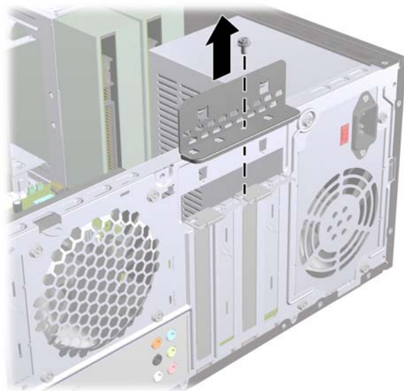
Figura 7 Abrir o fixador das tampas das ranhuras
