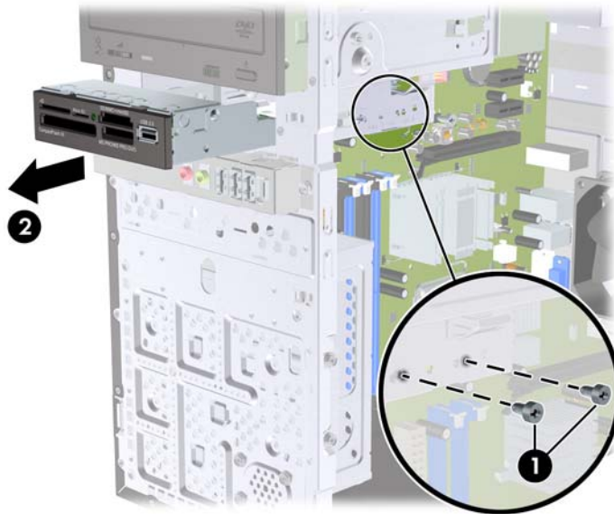
Figura 19 Remover um dispositivo de 3,5 polegadas (leitor de cartões multimédia mostrado)
