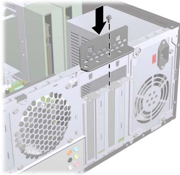
Figura 12 Fixar as placas de expansão e as tampas das ranhuras
