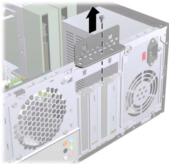
Slika 7 Odpiranje blokade pokrova reže
