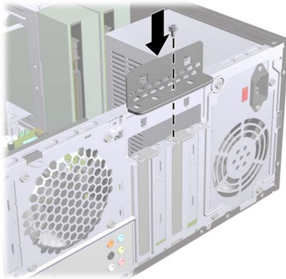
Slika 12 Odstranitev razširitvenih kartic in pokrovov rež
