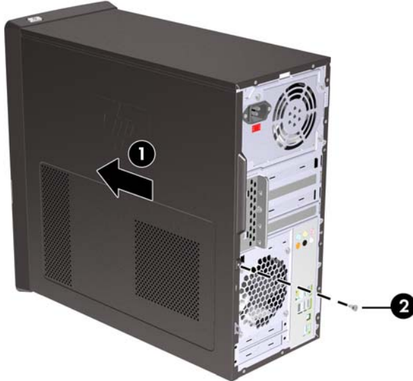
Slika 2 Vraćanje pristupne ploče računara
