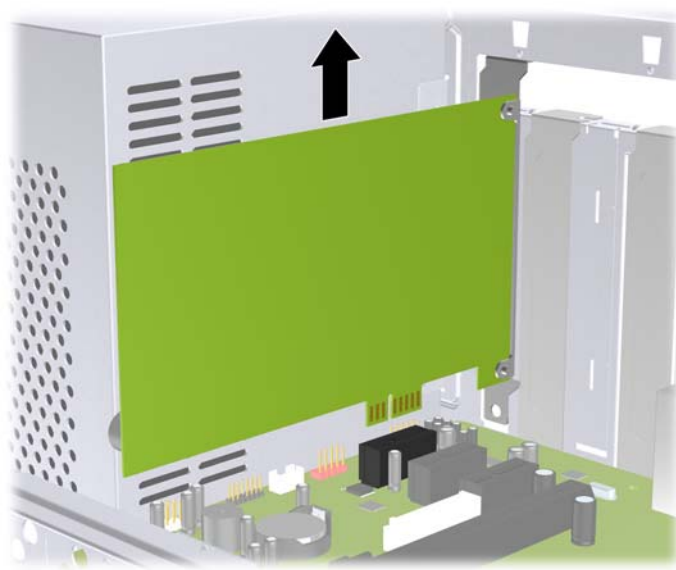
Slika 9 Uklanjanje PCI Express x1 kartice za proširenje
