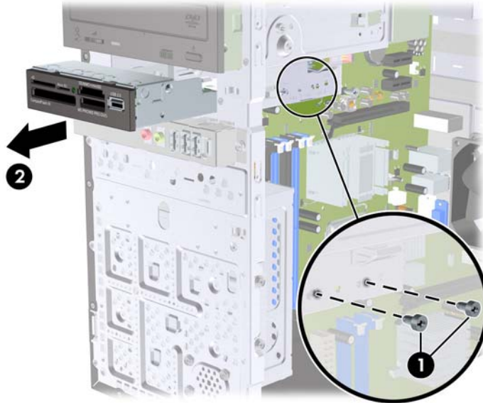
Figura 19 Extracción de un dispositivo de 3,5 pulgadas (Lector de tarjetas multimedia mostrado)
