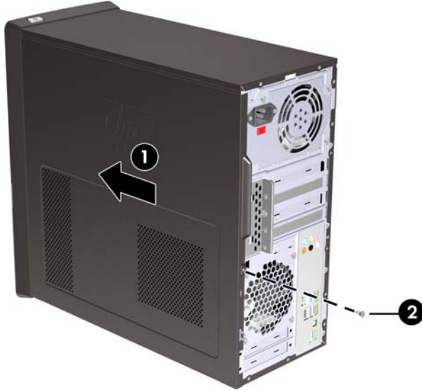
Figura 2 Reinstalación del panel de acceso del equipo
