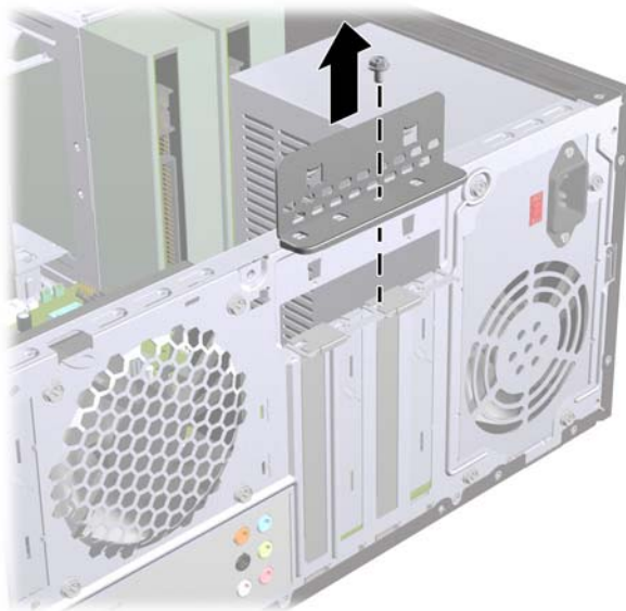
Figura 7 Apertura del bloqueo de cubierta de ranuras
