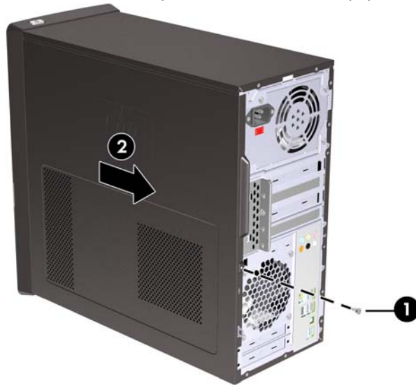
Figura 1 Extracción del panel de acceso del equipo
