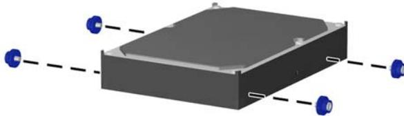
✍ **NOTA:** A unidade de disco rígido usa parafusos-guia 6-32 para montagem isolada. Oito parafusos-guia extras estão instalados no suporte da unidade de disco rígido embaixo do painel de acesso. Os parafusos-guia para montagem isolada, fornecidos pela HP, são prata e azul. Consulte [Instalação de unidades adicionais na página 22](#) para uma ilustração da localização dos parafusos-guia para montagem isolada 6-32 adicionais.
