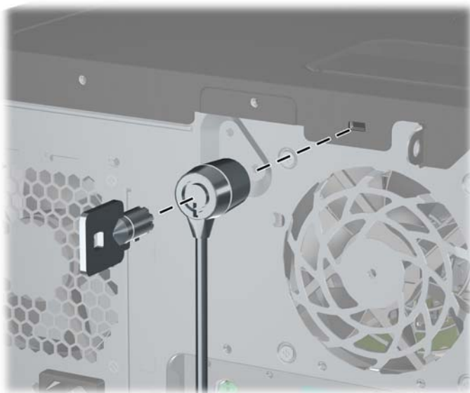
Figura 45 Instalación de un bloqueo de cable
