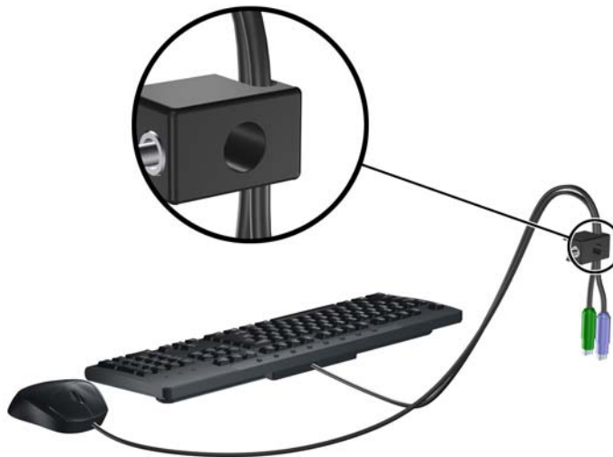
Figura 48 Enroscado de los Cables del Teclado y del Mouse
