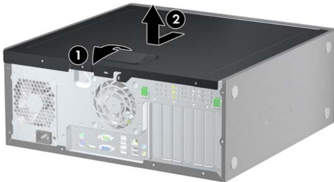
Figura 2 Extracción del panel de acceso de la computadora
