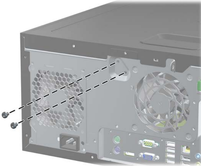
Figura 1 Extracción de los tornillos del bloqueo inteligente de cubierta
