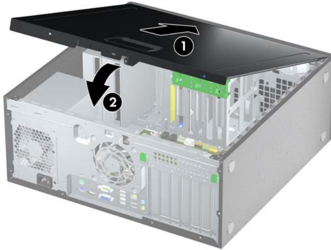
Figura 3 Reemplazo del panel de acceso de la computadora
