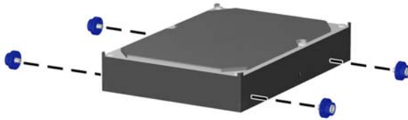
Figura 23 Instalar os parafusos-guia da unidade de disco rígido
