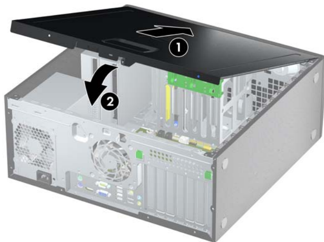
Figura 3 Voltar a colocar o painel de acesso do computador
