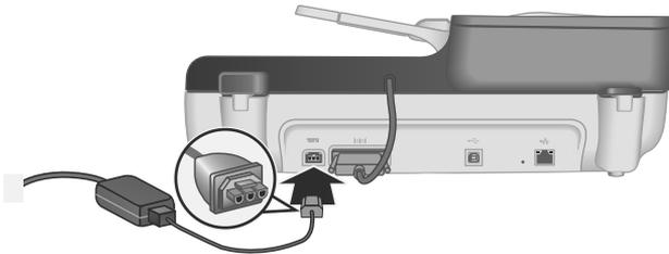
2. 將 AC 纜線較小的一端插回電源供應器背面。
