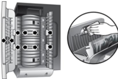
6. Warten Sie mehrere Minuten, bis die Einzugswalzen trocken sind, und schließen Sie dann die ADF-Walzenabdeckung und die Zugangsklappe.
