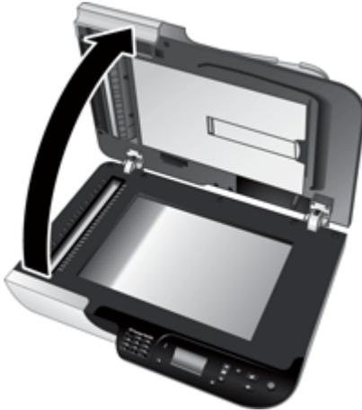
3. Reinigen Sie den weißen Streifen auf der Innenseite des Scannerdeckels und den durchsichtigen Scanstreifen auf dem Scannerglas. Wischen Sie diese Teile mit einem sauberen, angefeuchteten und fussel-freien Tuch ab.
