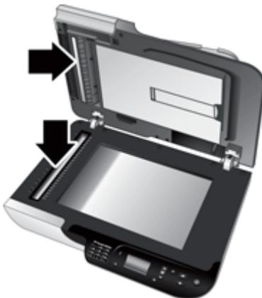
4. Öffnen Sie die ADF-Zugangsklappe (1) und die Walzenabdeckung (2) innerhalb des ADF.
