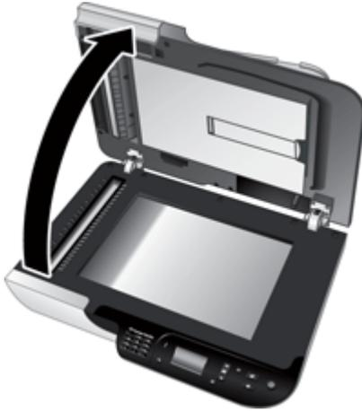
3. Limpie la tira blanca en el interior de la cubierta del escáner y elimine la tira de escaneo de la superficie del escáner. Limpie estos componentes con un paño limpio, húmedo y que no deje pelusa.
