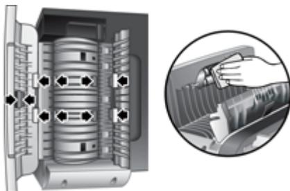
6. Espere varios minutos hasta que se sequen los rodillos y cierre la cubierta del rodillo del AAD y la puerta de acceso al AAD.
