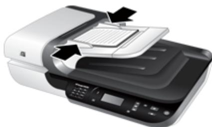
6. Empurre levemente a pilha para frente para ativar o sensor da bandeja.
