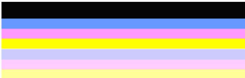
Пример качественных цветных полос. Все полосы должны быть сплошными, иметь четкие края, равномерно окрашены одним цветом и расположены поперек всей страницы. Принтер работает нормально.
