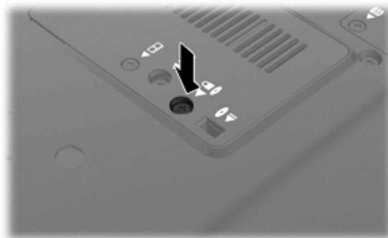
3. Substitua os 4 parafusos do disco rígido (1), e coloque depois as tampas dos parafusos protectores (2).
