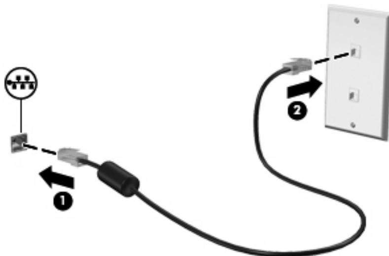
⚠ **AVISO!** Para reduzir o risco de choque eléctrico, incêndio ou danos ao equipamento, não ligue cabos de modem ou telefónicos a tomadas RJ-45 (rede).
