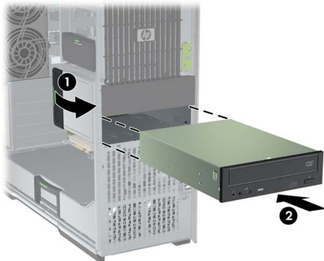
Figura 10-4 Instalación de la unidad óptica
