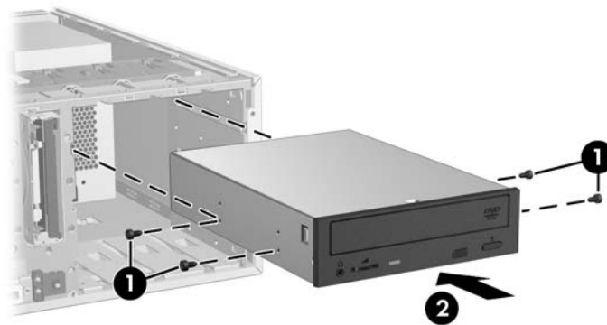
Figura 10-3 Instalación de la unidad óptica
