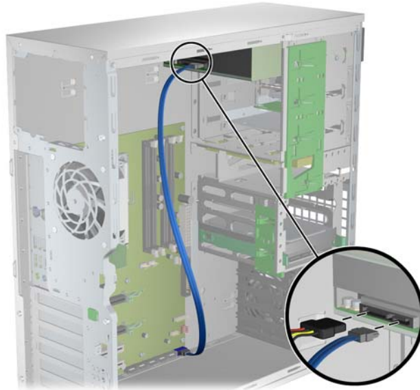
Figura 10-2 Conexión de los cables de datos y alimentación de la unidad ODD
