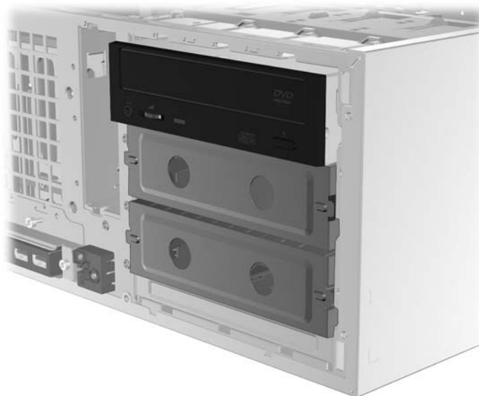
Figura 3-7 Reinstalación de la unidad óptica
