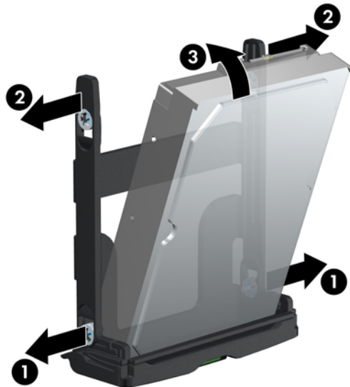
Figura 9-5 Instalación de la unidad en los rieles
