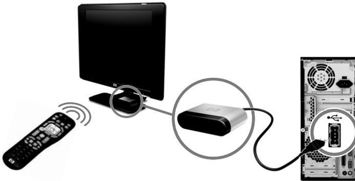
Untuk menggunakan remote control, arahkan remote control langsung ke posisi sensor jarak jauh. Jarak antara remote control dan sensornya maksimal 8 meter. Sudut remote control maksimal 22,5 derajat (total 45 derajat) dari titik tengah sensor jarak jauh.
