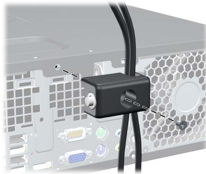
Figura 53 Acoplado del bloqueo al chasis
