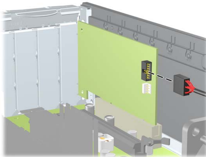
Figura 29 Desconexión del cable 1394 del lector de tarjetas multimedia
