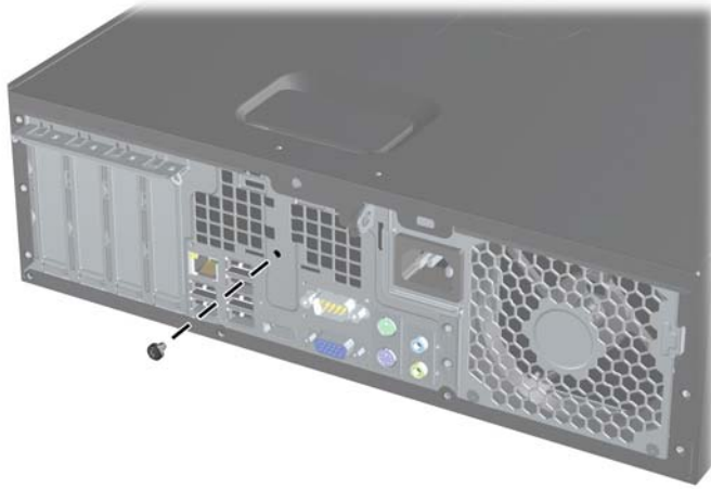
Figura 1 Extracción del tornillo del bloqueo inteligente de cubierta
