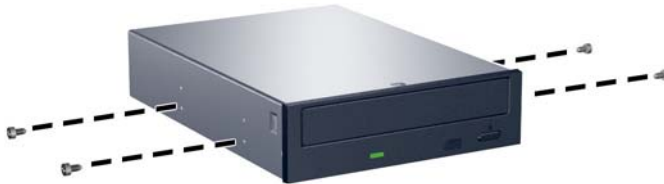
Figura 23 Instalación de tornillos guía en la unidad óptica
