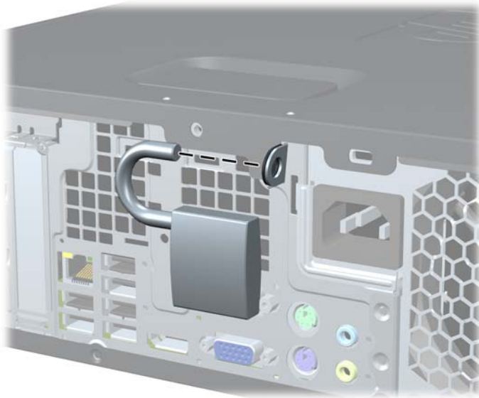
Figura 50 Instalación de un candado
