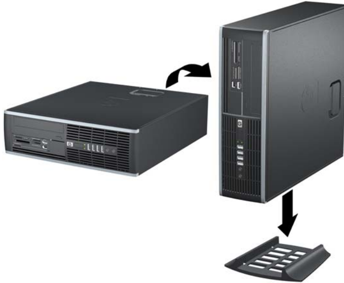
Figura 7 Cambio de configuración de desktop a torre
