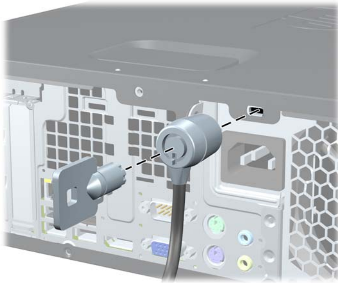
Figura 49 Instalación de un bloqueo de cable
