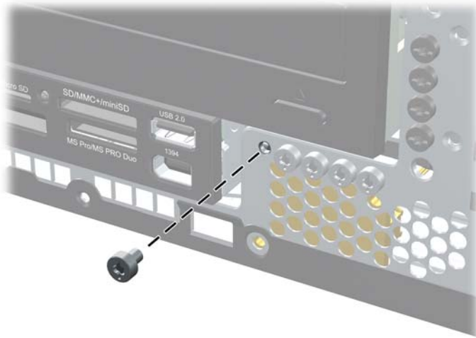
Figura 55 Extracción del tornillo de seguridad del panel frontal
