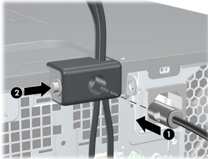
Figura 54 Activación del bloqueo
