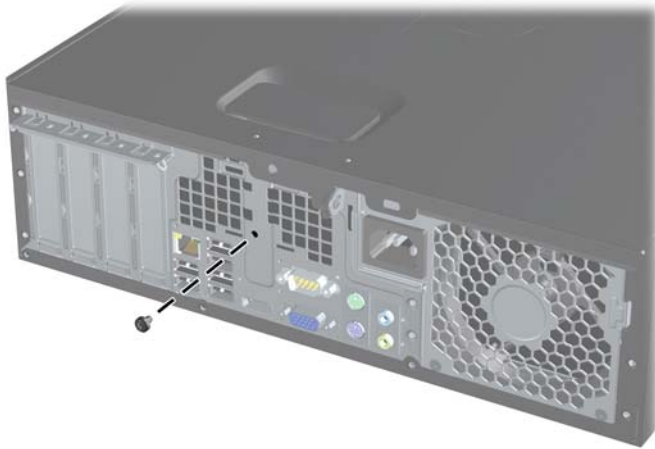
Obrázok 1 Vyberanie skrutky zámku Smart Cover Lock
