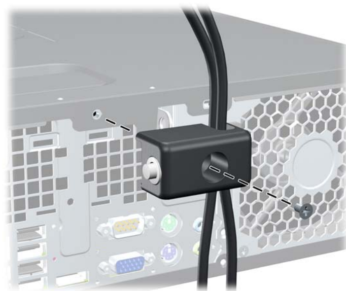
Obrázok 53 Pripojenie zámku k šasi
