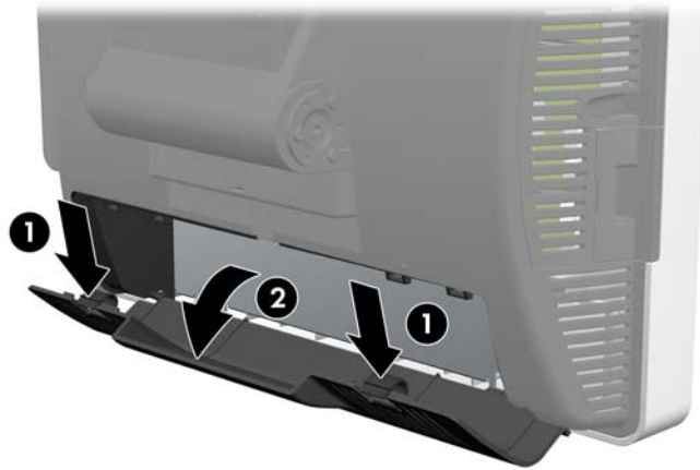
Figure 8 Retrait du cache d'E/S inférieur
