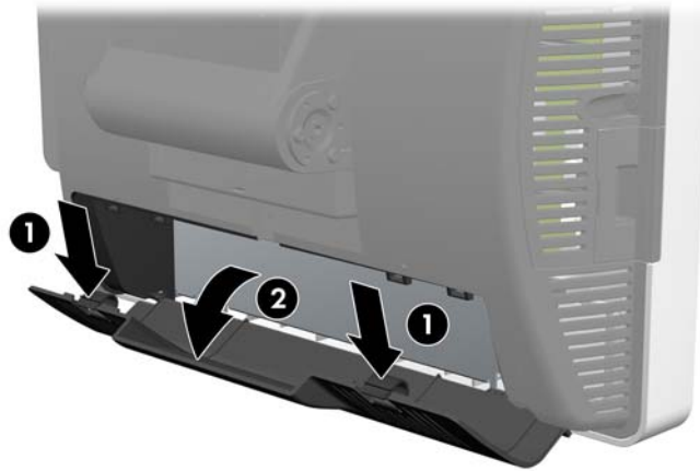
Figura 8 Extracción de la cubierta inferior de E/S
