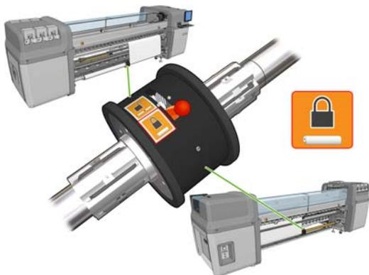
6. 新しいロール紙をスピンドルのギアの付いた側が左になるように、プリンタ背面のスピンドルに置きます。
