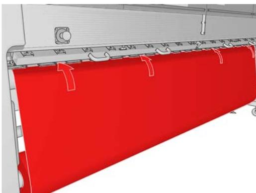
13. プリンタの前面に移動したとき、引き出した素材の長さが足りない場合は、素材をもう少し引き出せるように、フロントパネルの【メイン ローラー モーションの開始】を選択します。素材は引っ張ってロールから引き出してください。
