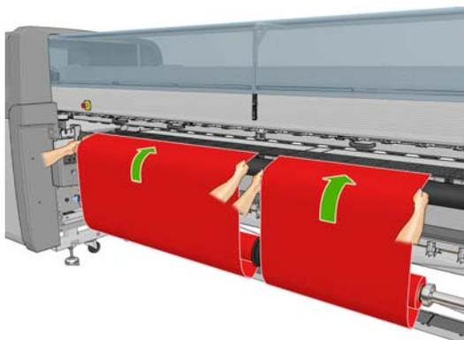
14. プリンタの前面に移動したとき、引き出した素材の長さが足りない場合は、素材をもう少し引き出せるように、フロントパネルの [素材] メニュー
