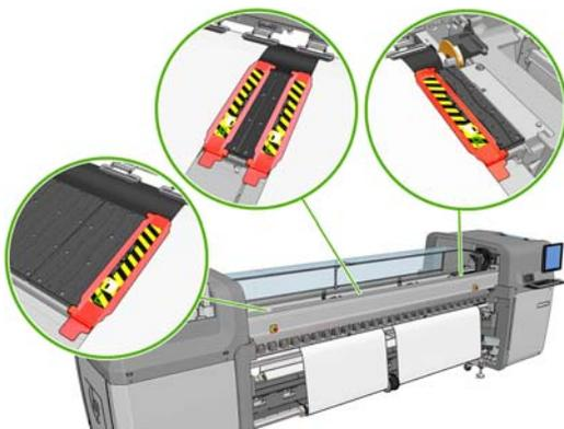
18. インพุット スピンドルとアウトプット スピンドルのディファレンシャルのロックを解除します。
