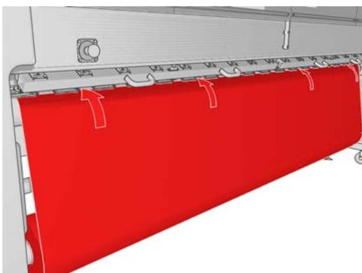
12. プリンタの前面に移動したとき、引き出した素材の長さが足りない場合は、素材をもう少し引き出せるように、[メイン ローラー モーションの開始] を選択します。素材は引っ張ってロールから引き出してください。
