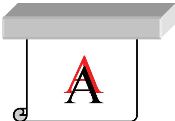
Se as impressões em magenta forem mais baixas no substrato do que as outras cores, diminua a configuração de avanço de substrato no HP Internal Print Server.
