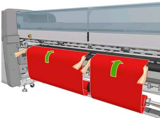
14. Bringen Sie die mittleren Kantenhalter an, was zu diesem Zeitpunkt sehr einfach durchgeführt werden kann.
