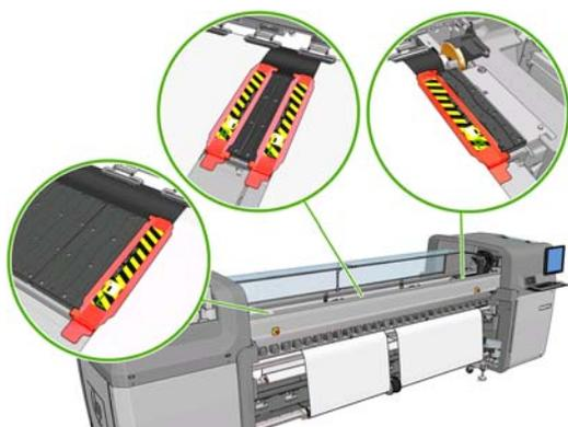
19. Entsperren Sie die Differentiale an den Eingangs- und Ausgangsspindeln.
