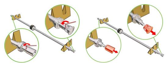
4. Desatornille y retire la parte interior de cada disco.
