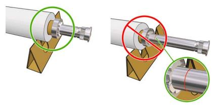
10. Asegúrese de que el adaptador del rodillo encaje firmemente en el disco.
