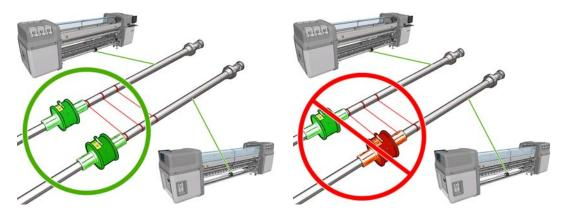
2. Une fois les moyeux différentiels correctement positionnés, maintenez-les en place en serrant les vis à l'aide d'une clé Allen 6. Si l'un d'entre eux n'est pas bien monté, le substrat risque de se mettre en biais en cours d'impression.
