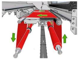
REMARQUE: Vous pouvez charger le substrat avec la face imprimée orientée vers l'intérieur ou l'extérieur, auquel cas la bobine tournera dans le sens contraire///. L'imprimante vous demandera quelle est la direction de bobinage si elle ne l'a pas détectée automatiquement.
