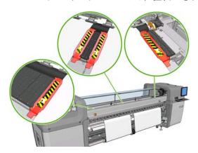
**19**. インプット スピンドルとアウトプット スピンドルのディファレンシャルのロックを解除します。
