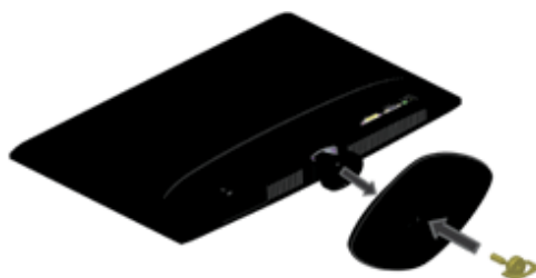
Figur 3-1 Installering af foden
