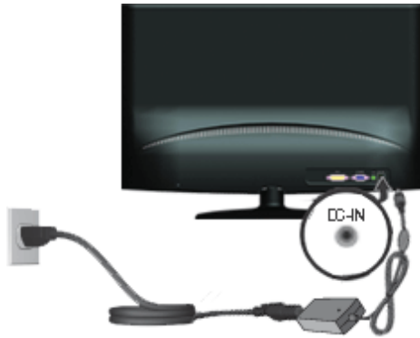
Figur 3-4 Tilslutning af el-ledningen
