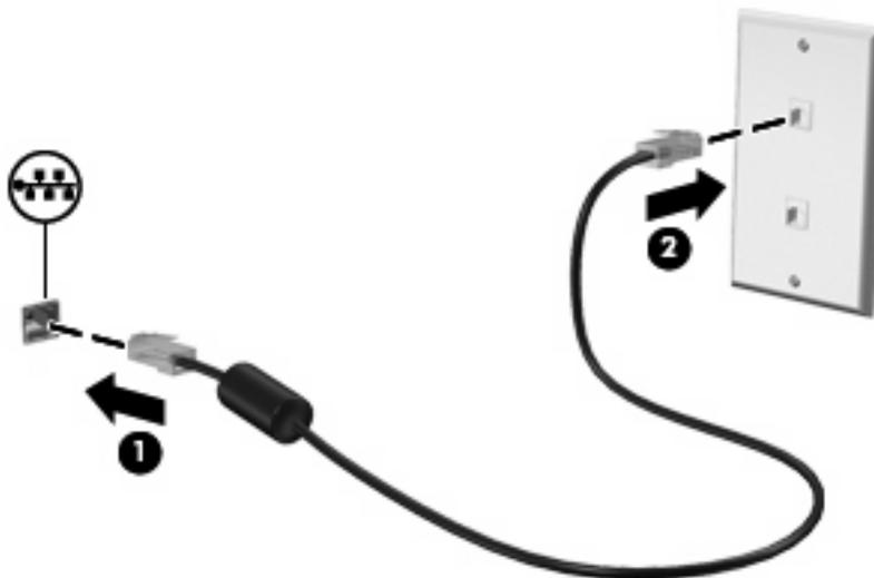
**⚠ VORSICHT!** Um Stromschlag- und Brandgefahr sowie eine Beschädigung der Geräte zu vermeiden, stecken Sie kein Modem- oder Telefonanschlusskabel in die RJ-45-Netzwerkbuchse.
