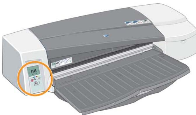
El panel frontal tiene dos luces (LED), tres botones para controlar las operaciones de impresión y una pantalla de visualización que proporciona información.
