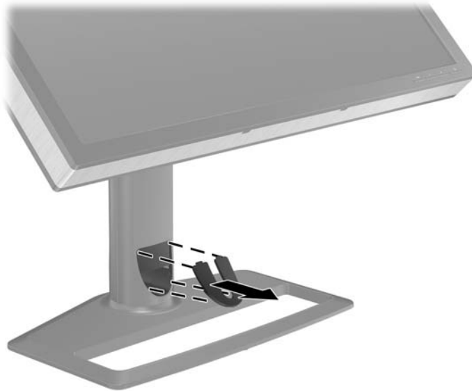
Abbildung 3-3 Entfernen der Kabelführungsblende
