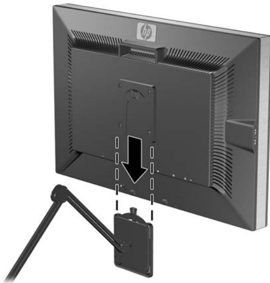
Abbildung 3-13 Anbringen des Monitorbildschirms an der Schnellverriegelung
