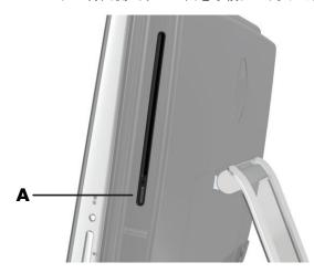
ディスクを取り出すには、電源が入っていることを確認してから、ディスクドライブ側面の取り出しボタン (A) を押します。または、[スタート]ボタン→[コンピューター]の順にタップし、ドライブのアイコンを 押したままにして(マウスの場合は右クリックして)、「取り出し]をタップします。
