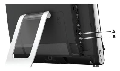
テレビケーブルを、コンピューター背面のコネクターカバー内にある地上デジタル用(上の図の A)、BS・CS 用(上の図のB)コネクターに接続します。7ページの「HP TouchSmart PC の背面」を参照してください。 B-CAS カードを B-CAS カードスロット (下の図の A) に挿入します。
