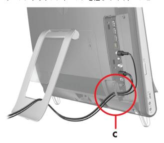
3 コネクターカバーを取り付けるには、カバーの右端のフックをコンピューターのスロットに合わせて、カ チッという音がするまで押します。次に、コンピュータースタンドの切り込み部分にケーブルを通しま す (**D**)。
