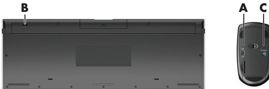
如果仍然无法使用，请从电脑背面将无线键盘和鼠标接收器拆下并重新装上，然后再次同步键盘和鼠标。
