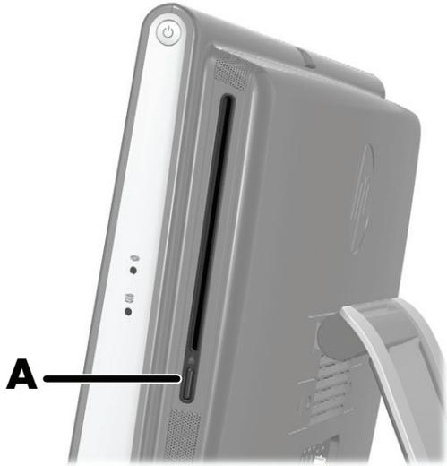
要弹出光盘，请确保在电源接通的情况下，按光驱一侧的弹出按钮 **(A)**。还可依次单击**开始按钮**、**计算机**，按住（或者使用鼠标右键单击）**CD 光驱**，然后单击**弹出**。
