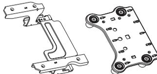
安装在电脑背面，该组件用于在电脑上安装单独的墙上安装硬件（未提供）。
