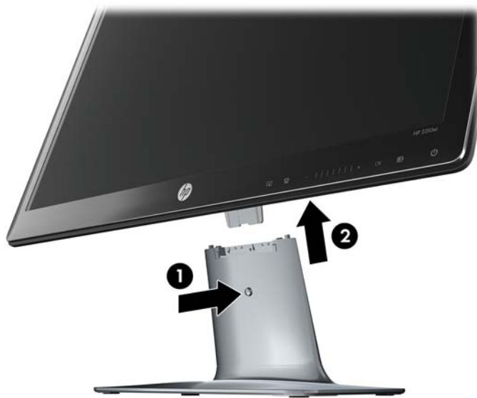
Figur 2-1 Aftagning af skærmsoklen
