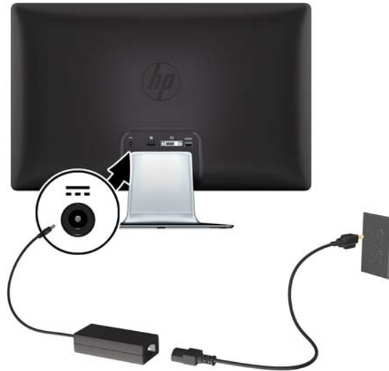
Figur 3-6 Tilslutning af strømkablet
