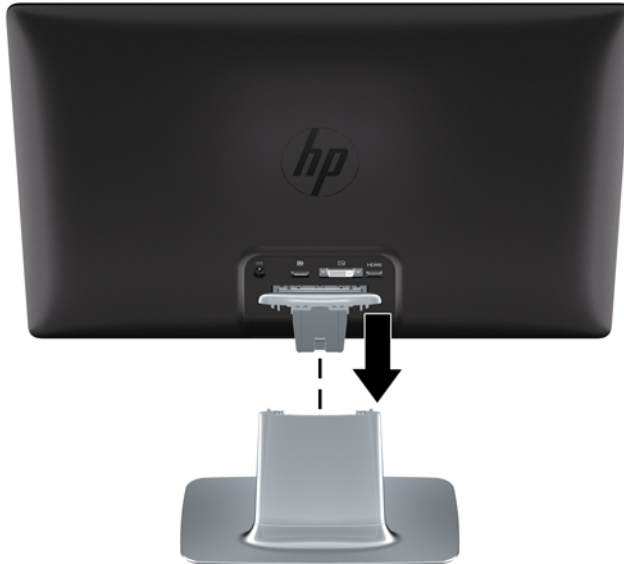
Kuva 3-2 Näytön paneelin paikalleen asettaminen
