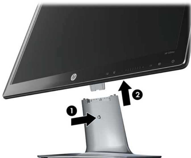
Kuva 2-1 Näytön paneelin irrottaminen
