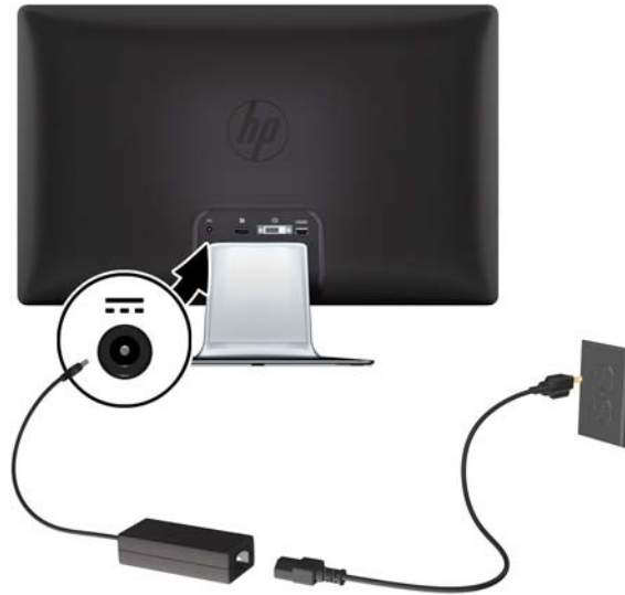
Afbeelding 3-6 Het netsnoer aansluiten
