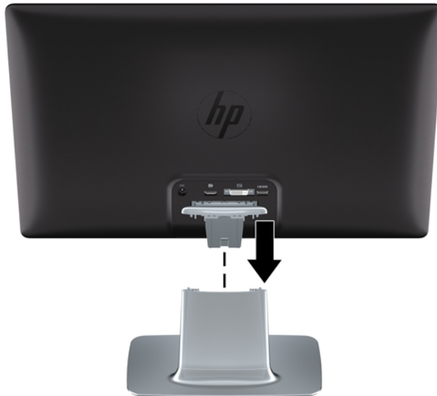
Gambar 3-2 Memasukkan Panel Monitor
