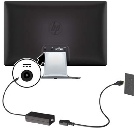
Gambar 3-6 Menyambungkan Kabel Daya
