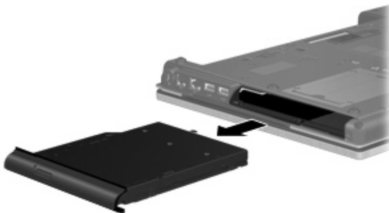
Per installare un'unità ottica nell'alloggiamento di espansione:
