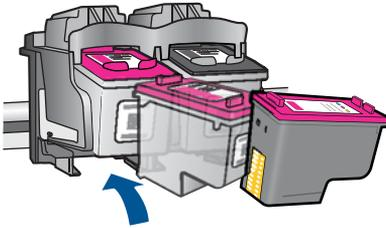
8. Tire o cartucho colorido do slot da esquerda. Pressione o cartucho para baixo e, em seguida, puxe-o em sua direção para removê-lo do slot.
