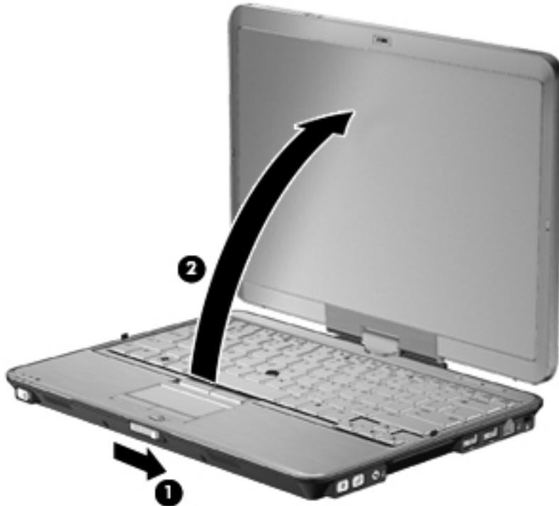
3. Faites pivoter l'écran de l'ordinateur dans le sens inverse des aiguilles d'une montre jusqu'à ce qu'il soit en place et se retrouve face au clavier.
