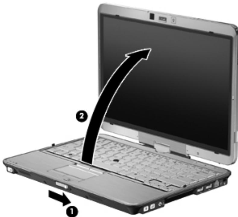
2. Faites pivoter l'écran de l'ordinateur dans le sens des aiguilles d'une montre jusqu'à ce qu'il soit en place et tourne le dos au clavier.
