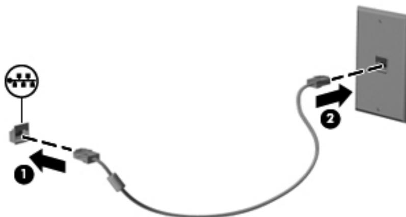
**⚠ AVERTISSEMENT !** Afin de réduire les risques d'électrocution, d'incendie ou de détérioration du matériel, ne branchez pas de câble modem ou téléphonique sur la prise réseau RJ-45.
