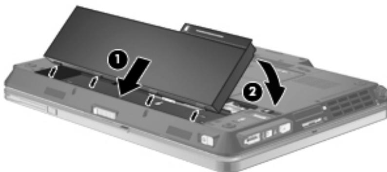
Для извлечения аккумуляторной батареи выполните следующие действия.
