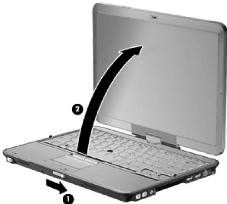
3. Поверните экран компьютера против часовой стрелки до фиксации, чтобы лицевая часть экрана была обращена к клавиатуре.
