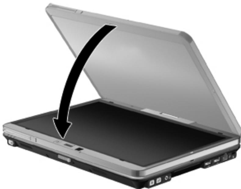
При работе в планшетном режиме изображение на экране автоматически переводится в книжную или альбомную ориентацию при повороте.
