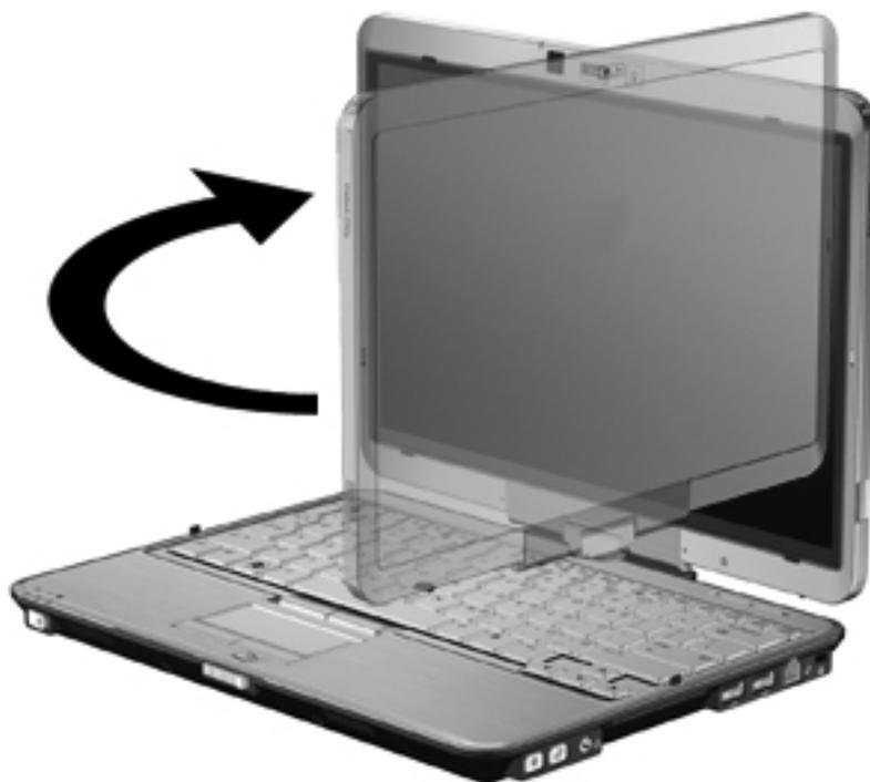
3. Опустите экран компьютера на клавиатуру до фиксации со щелчком.
