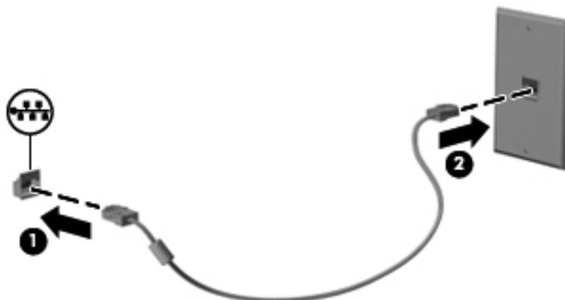
**⚠ ВНИМАНИЕ!** Во избежание поражения электрическим током, возгорания или повреждения оборудования не вставляйте модемный или телефонный кабель в разъем RJ-45 (локальная сеть).
