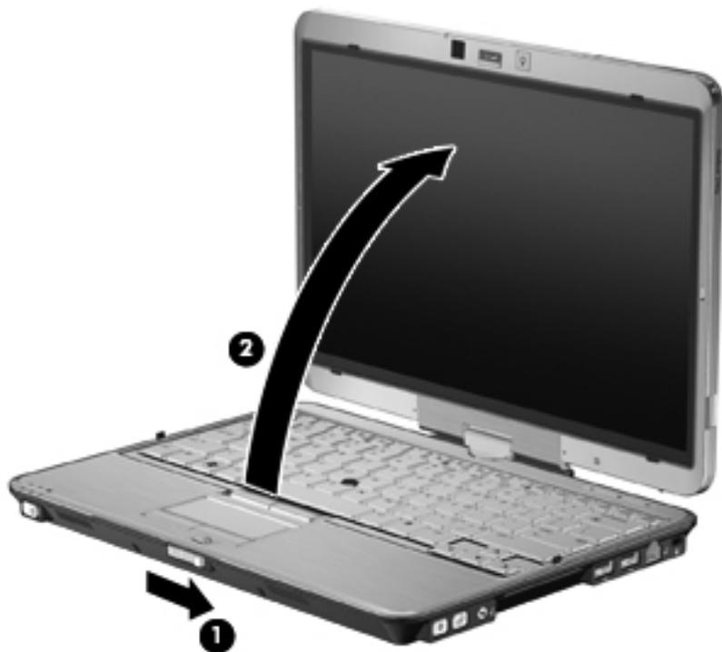
2. Поверните экран компьютера по часовой стрелке до фиксации, чтобы лицевая часть экрана была обращена от клавиатуры.
