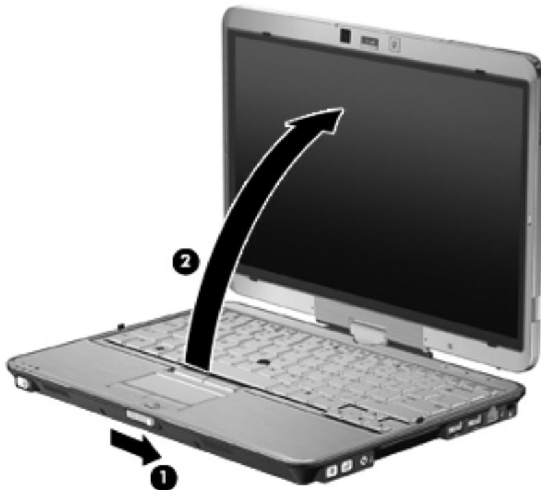
2. Gire la pantalla del equipo hacia la derecha hasta que se ajuste en su posición y quede en dirección opuesta al teclado.
