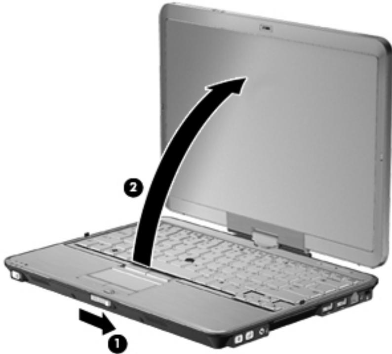
3. Rote la pantalla del equipo hacia la derecha hasta que encaje de cara al teclado.
