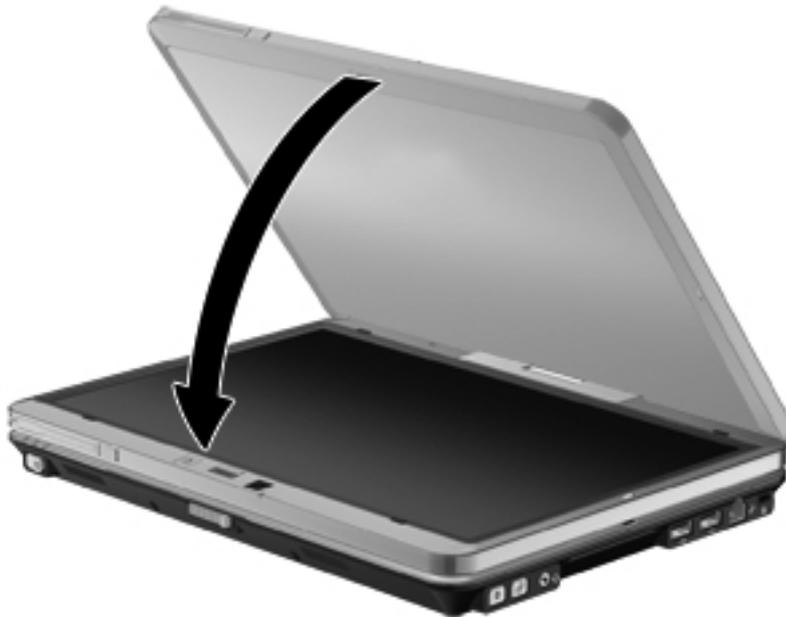
En el modo tablet, la pantalla rota automáticamente desde la posición vertical hasta la horizontal a medida que se gira.
