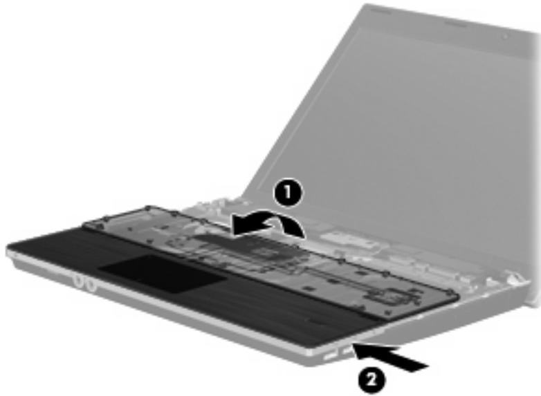
5. Setzen Sie die Schrauben wieder in die Handauflage ein.
