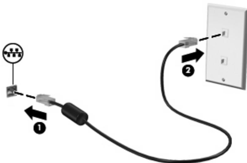
**⚠ AVISO!** Para reduzir o risco de choque elétrico, incêndio ou danos ao equipamento, não conecte um cabo de modem ou de telefone no conector RJ-45 (rede).
