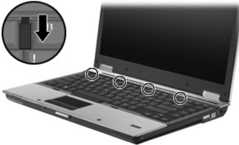
10. Soulevez délicatement le bord supérieur du clavier et faites pivoter le clavier jusqu'à ce qu'il s'appuie sur le repose-poignet de l'ordinateur.
