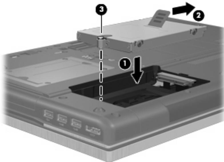
4. Alinhe as linguetas (1) da tampa da unidade de disco rígido com os encaixes do computador.
