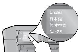
Mindenképpen kövesse a készülék kijelzőjének utasításait, amely végigvezeti a HP Photosmart üzembe helyezésén és csatlakoztatásán, többek között a patronok behelyezésén és a vezeték nélküli kapcsolat beállításán.
