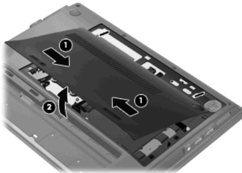
8. 以下の手順に沿って操作し、既存のメモリ モジュールを取り外します。
